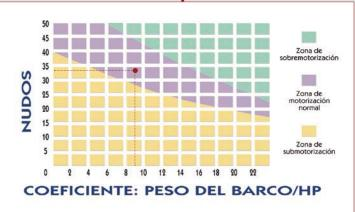
Este gráfico nos permite apreciar si la potencia del motor Mercury 115 SeaPro XS de 115 Hp de la Quicksilver Activ 555 Cabin es la adecuada o si, por el contrario, está por encima o por debajo de la considerada óptima en función del coeficiente peso/ Hp y la velocidad máxima alcanzada.
